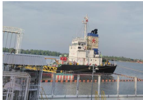
ภาพที่ 8 การล่อมทุ่นดักน้ำมันล้อมรอบเรือ
